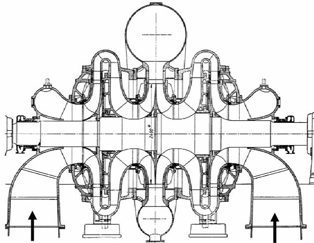
Abb. 7.18. Zweiflüglige, zweistufige Speicherpumpe,  $D = 170-190$  mm,  $\dot{V} = 14,5$  m<sup>3</sup>/s,  $n = 333$  U/min,  $P_{max} = 27600$  kW. Geschweißtes Spritzgussgehäuse, Laufräder der ersten Stufe aus Chromstahlblech, für die zweite Stufe, Saugkrümmer und übriges Gehäuse aus Stahlguß (Pumpenspeicherwerk Reitsch-Rabenlothe, Voith)
