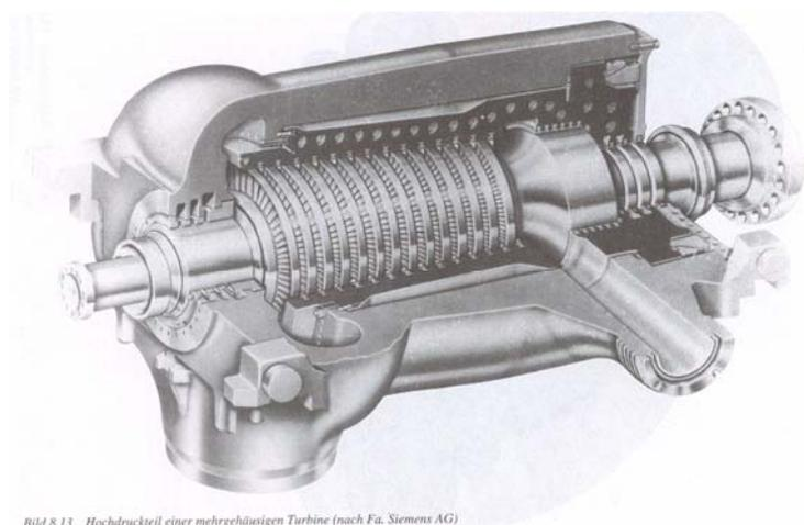
Bild 8.13 Hochdruckteil einer mehrgewässigen Turbine (nach Fa. Siemens AG)
