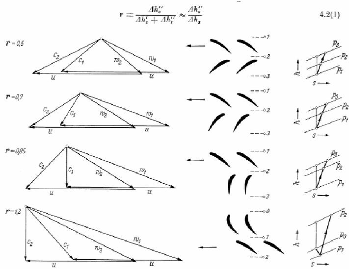
Abb. 4.2.3 Axialverdichterschaufelungen verschiedenen Reaktionsgrades.
