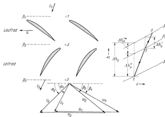
Abb. 4.2.2 Arbeitsweise einer Axialverdichterstufe.
