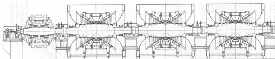
Bild 8.18 1200-MW-Dampfturbosatz eines Kernkraftwerkes (nach Fa. Siemens AG)
