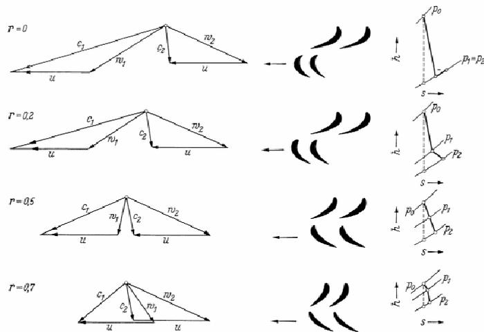
Abb. 4.1.3 Turbinenschaukelungen verschiedener Reaktionsgrade.
